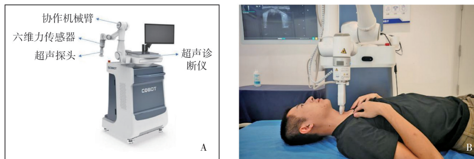
图1 自动扫查超声机器人与检查示意图
